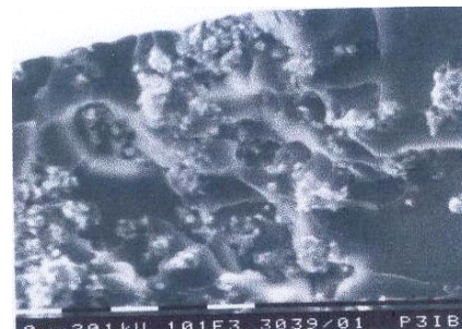
Gambar 3. BaM 40 % + PE 60 % + 10 mL silane (SEM perbesaran 1010 X).
