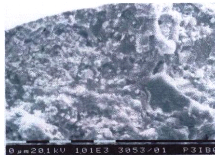
Gambar 4. BaM 50% + PE 50% + 10 mL silane (SEM perbesaran 1010 X).
