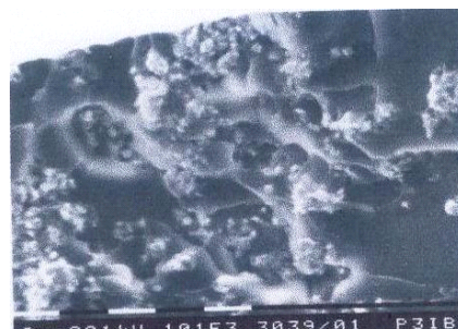
Gambar 3. BaM 40 % + PE 60 % + 10 mL silane (SEM perbesaran 1010 X).
