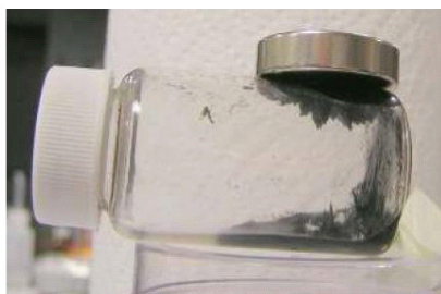
Gambar 4. Fluida magnetik Fe_3O_4 + tetrametil amonium hidroksida dalam pengaruh magnet permanen.
