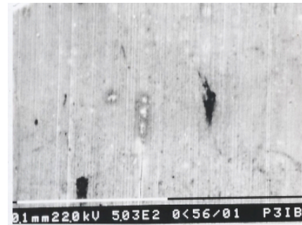
Gambar 4. Struktur mikro permukaan corten , hasil sputtering Al selama 3 jam (500x).
