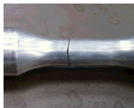
Gambar 10. Patahan akhir pada pembebanan tarik-tekan hasil percobaan.
