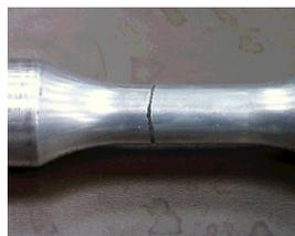
Gambar 10. Patahan akhir pada pembebanan tarik-tekan hasil percobaan.
