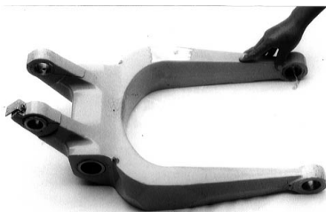
Gambar 3. Foto kondisi visual secara utuh Nose landing gear dari pesawat terbang yang telah mengalami patah pada dudukan bushing .
