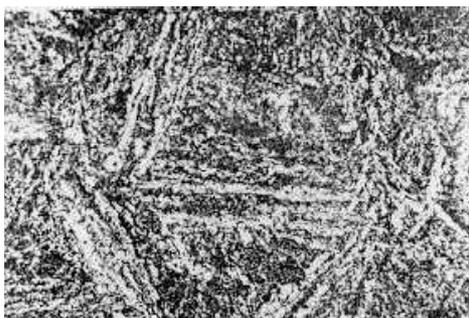
Gambar 1. Strukturmikro substrat AISI 4340 (Nital, 500 X)
