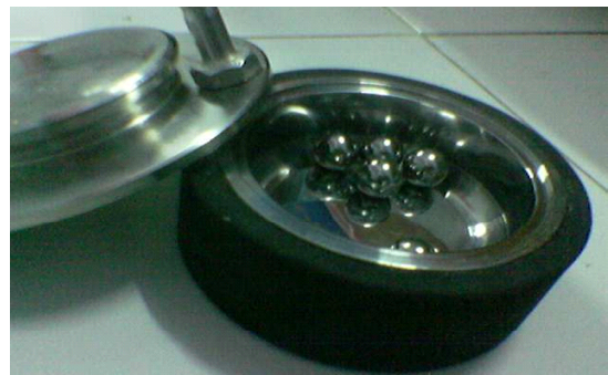
Gambar 2. Vial dan bola baja yang digunakan untuk proses penggerusan dalam suasana inert dengan menggunakan VBM.
