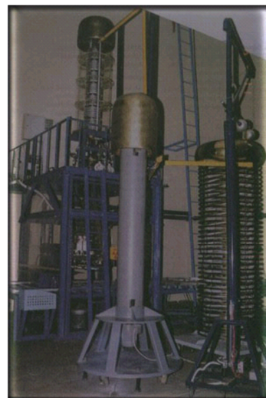
Gambar 5. Mesin berkas elektron 350 KeV/10 mA
