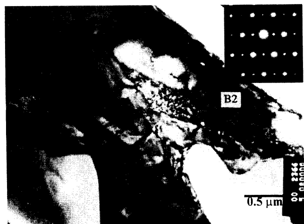
Gambar 3. Strukturmikro sampel yang telah diperlakukan panas selama satu jam pada temperatur 1300 °C dan diquench ke dalam nitrogen cair.
