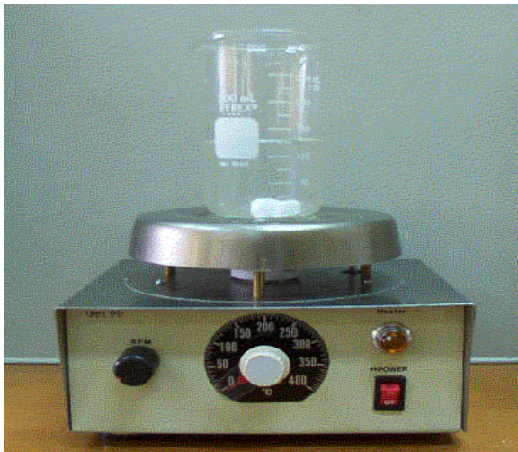
Gambar 1. Alat magnetic stirrer dengan penggerak motor dc menggunakan magnet buatan P3IB
