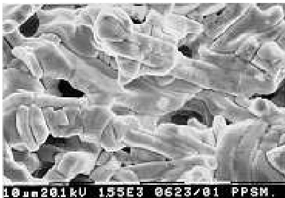
Gambar 13. Struktur mikro pada Y-123 hasil proses sintering
