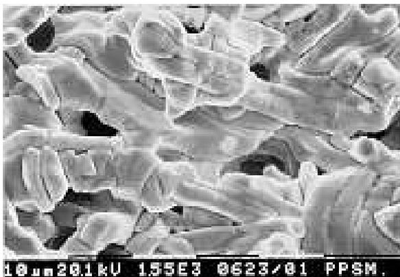
Gambar 13. Struktur mikro pada  $Y-123$  hasil proses *sintering*
