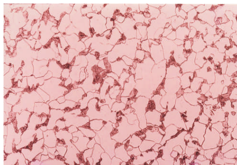
Gambar 3. Strukturmikro baja SC 10 suhu annealing 1000°C, 45 menit
