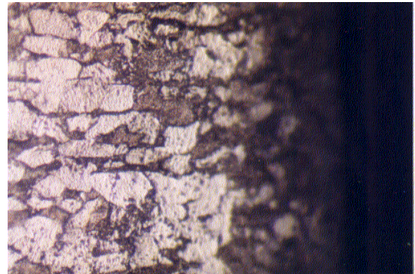
Gambar 9. Strukturmikro pada penampang melintang dari material baja ST 40 sesudah proses karburasi dengan suhu 300 °C dan waktu deposisi 3 jam. (Nital 3%, perbesaran 100 X).
