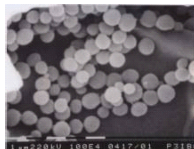
Gambar 4. Foto SEM partikel \text{Fe}_3\text{O}_4 berlapis PLA ( \text{Fe}_3\text{O}_4/\text{PLA} ) yang dibuat dengan metode sonokimia. Perbesaran 10.000 X.
