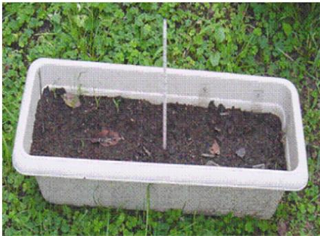
Gambar 6. Pot bunga plastik yang digunakan dalam *soil burial test*.
