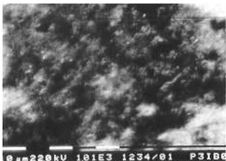
Gambar 8. Strukturmikro permukaan baja *Cor-Ten* pasca deposisi Al, nitridasi dan oksidasi pada 650 °C selama 50 jam citra elektron sekunder.
