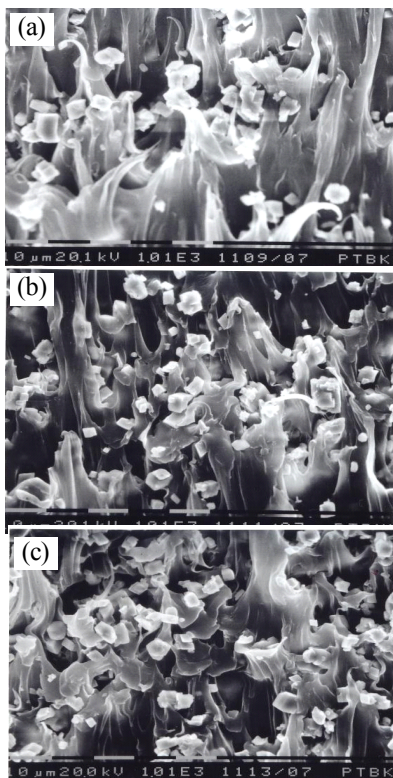
Gambar 3. Struktur mikro komposit PP-CaCO 3 dengan variasi komposisi CaCO 3 , (a) 30% CaCO 3 , (b) 40% CaCO 3 , (c) 45% CaCO 3
