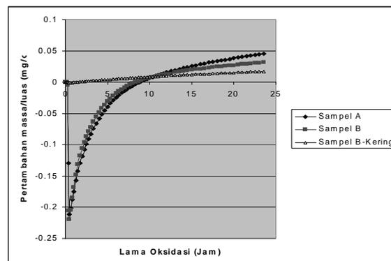
Gambar 5. Kurva TiAl hasil uji korosi dengan *MSB*.
