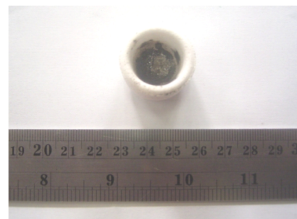
Gambar 2. Crucible yang digunakan untuk proses metalisasi
