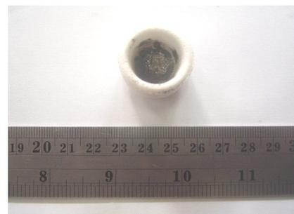
Gambar 2. Crucible yang digunakan untuk proses metalisasi
