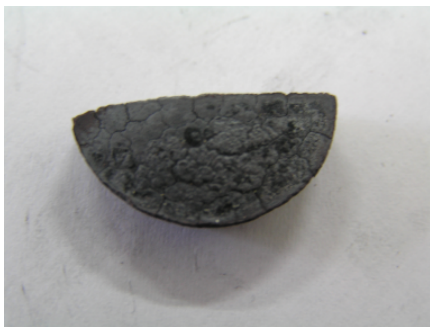
Gambar 8. Metalisasi pasir besi grafit dengan suhu 1400 °C.
