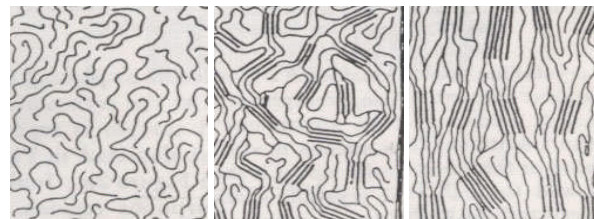
Gambar 3. Bentuk polimer amorf, kristalin dan kristalin terorientasi [5].
