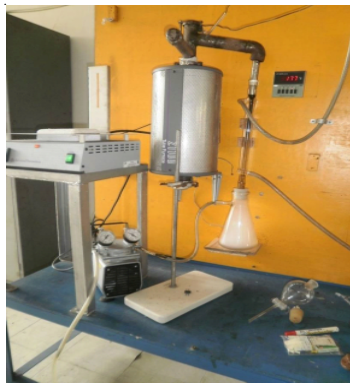
Gambar 2. Rekayasa alat pirolisis (Lab Scale)
