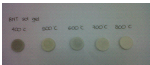
Gambar 4. Perbandingan BNT yang disinter dengan suhu yang divariasikan.
