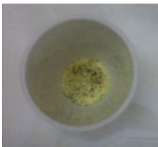
Gambar 3. Hasil Sintering BNT dengan suhu sinter 400 °C
