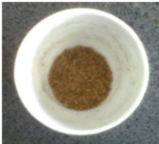
Gambar 2. Hasil kalsinasi BNT pada suhu 170 °C
