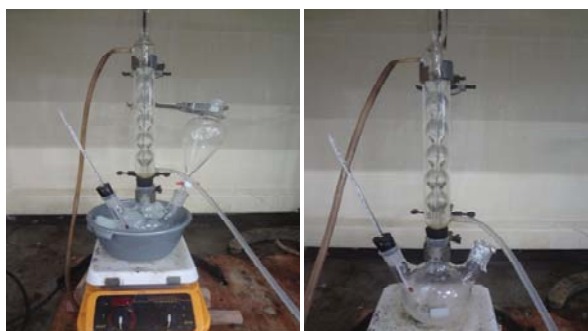
Gambar 1. Skema alat pencampuran pada suhu 0 °C (kiri) dan suhu tinggi (kanan).
