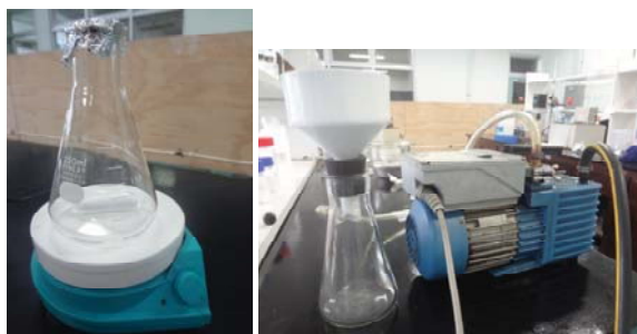
Gambar 2. Skema alat pencampuran pada suhu kamar (kiri) dan penyaringan secara vakum (kanan).
