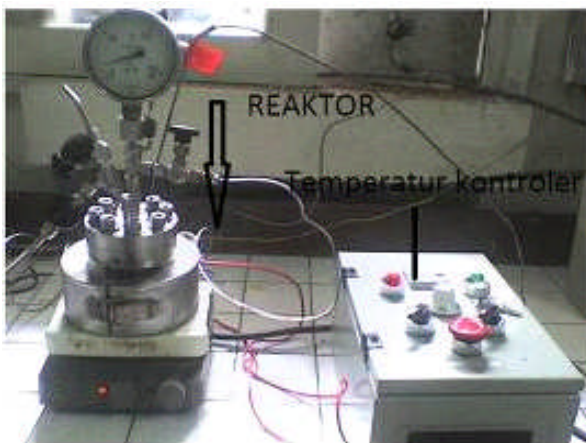
Gambar 3. Reaktor untuk konversi gliserol mejadi propandiol.
