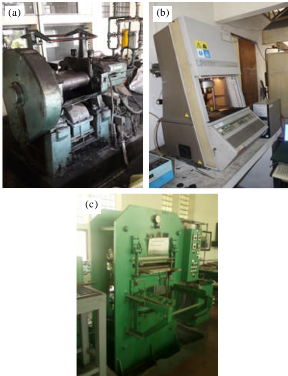
Gambar 1. (a). Alat pembuat kompon, (b). alat uji karakteristik vulkanisasi kompon dan (c). alat pencetak vulkanisat.
