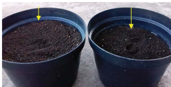
Gambar 3. Tanah dicampur 0,5% hidrogel (kiri) dan tanpa hidrogel (kanan) yang dijenuhi air.
