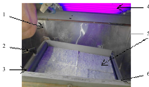
Gambar 4. Bagian dalam reaktor alir fotokatalitik
