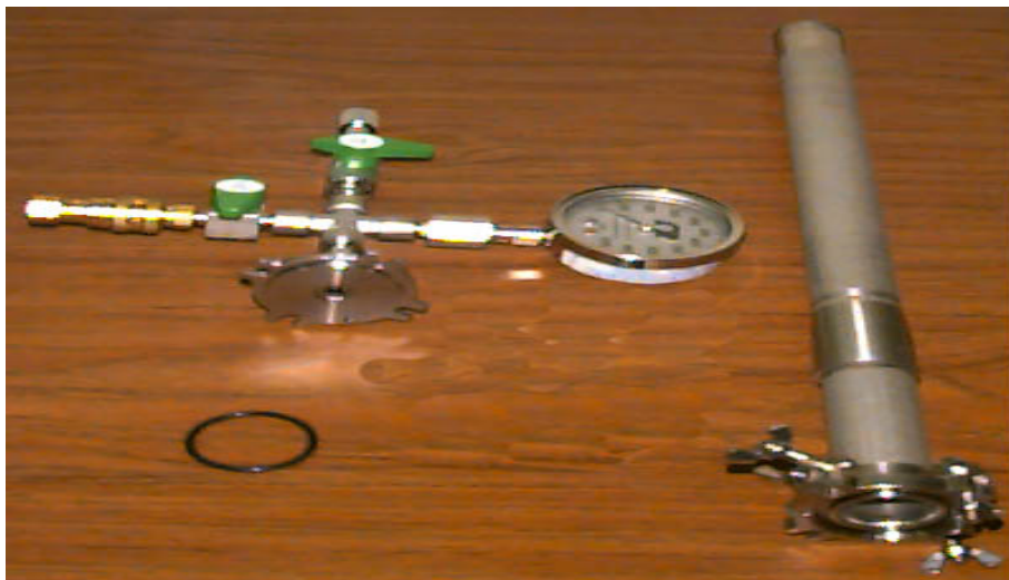
Gambar 1. Tabung dissolver yang terbuat dari baja tahan karat tipe 304.
