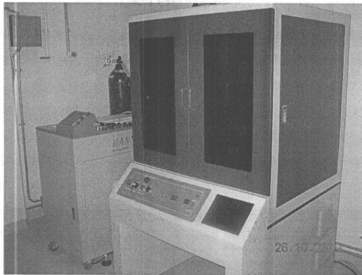
**Gambar 4.** Fasilitas *laser welder* untuk pembuatan *seed I-125*
