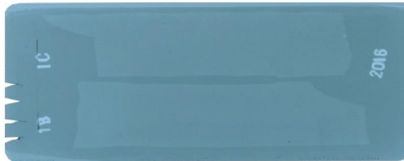
Gambar 13. Hasil pemindaian film radiografi sinar-X pada Terumbu Karang dengan 4 filter screen Pb.
