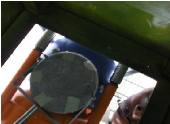
Gambar 6. Window dengan filter screen Pb. Gambar 7. Set up radiografi sinar-X.
