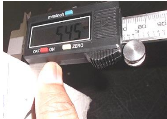
Gambar 2. Tebal Terumbu Karang 5,45 mm
