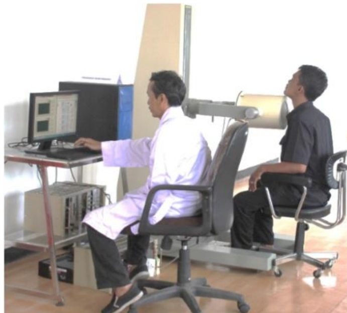
Gambar 1. Proses pendeteksian menggunakan perangkat scintigrafi untuk tiroid SC-12 [1]
