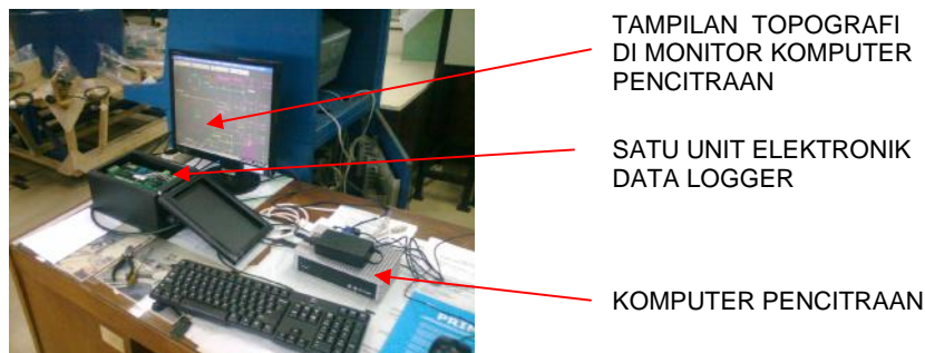
Gambar 6. Blok sistem elektronik data logger dan tampilan topografi di komputer pencitraan
