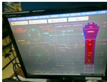
Gambar 11. Bejana proses berisi sample, tanpa pemancar gamma dan bentuk tampilan topografinya di komputer pencitraan
