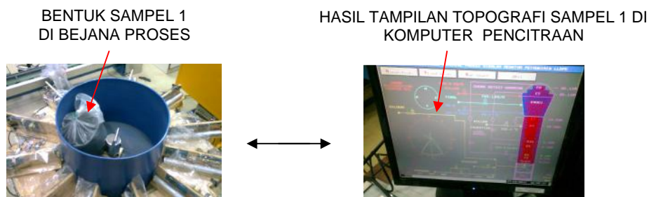
Gambar 7. Bejana proses berisi sampel 1 dan bentuk tampilan topografinya di komputer pencitraan
