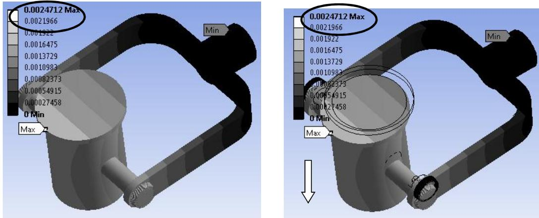
Gambar 10. Deformation yang terjadi setelah diberi beban maksimum.
