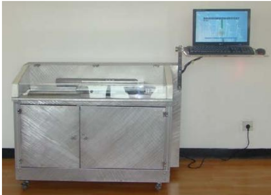
Gambar 3b. Perangkat RIA IP10.1 untuk diagnosis kelenjar gondok setelah dilakukan penambahan cover sistem mekanik.
