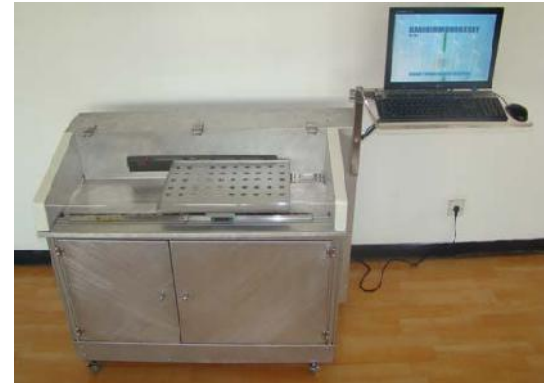
Gambar 3b. Perangkat RIA IP10.1 untuk diagnosis kelenjar gondok setelah dilakukan penambahan cover sistem mekanik.
