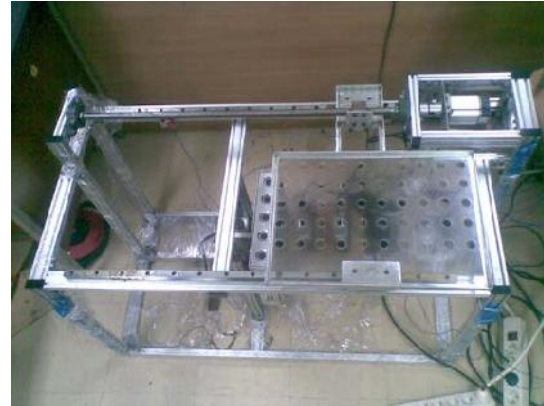
Gambar 3a. Perangkat RIA IP10.1 untuk diagnosis kelenjar gondok sebelum dilakukan penambahan cover sistem mekanik.
