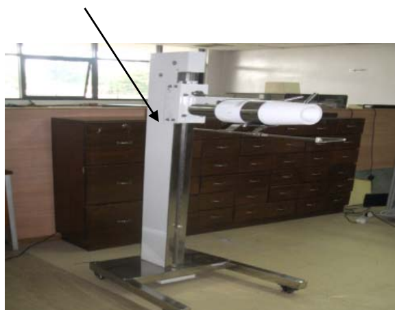
Gambar 3. Perangkat thyroid uptake (lama) dengan satu buah detektor [1]
