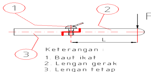
Gambar 7. Lengan gerak horisontal bertumpu pada lengan itu sendiri
