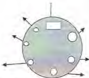
Gambar 5. Penempatan Melintang Pinhole Detektor
