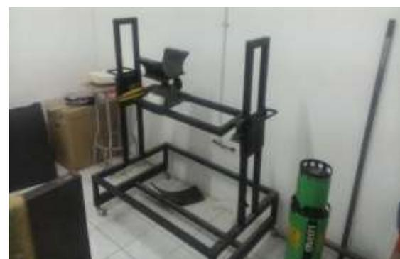
**Gambar 5.** Sistem Mekanik Pengatur Tabung Sinar-X Lorad LPX 200.
