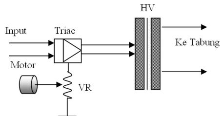
Gambar 5. Blok Diagram Alat Pengatur HV<sup>[3]</sup>
