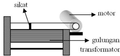
Gambar 4. Konstruksi Auto Transformator dan Motor Penggerak Sikat
