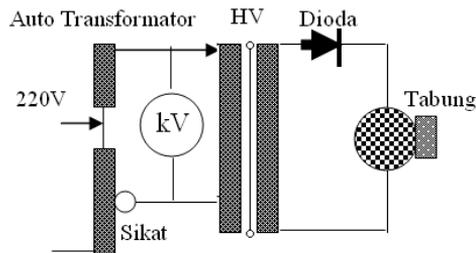
Gambar 1. Blok Diagram Sistem hv Pesawat sinar-X Diagnostik<sup>[1]</sup>.
