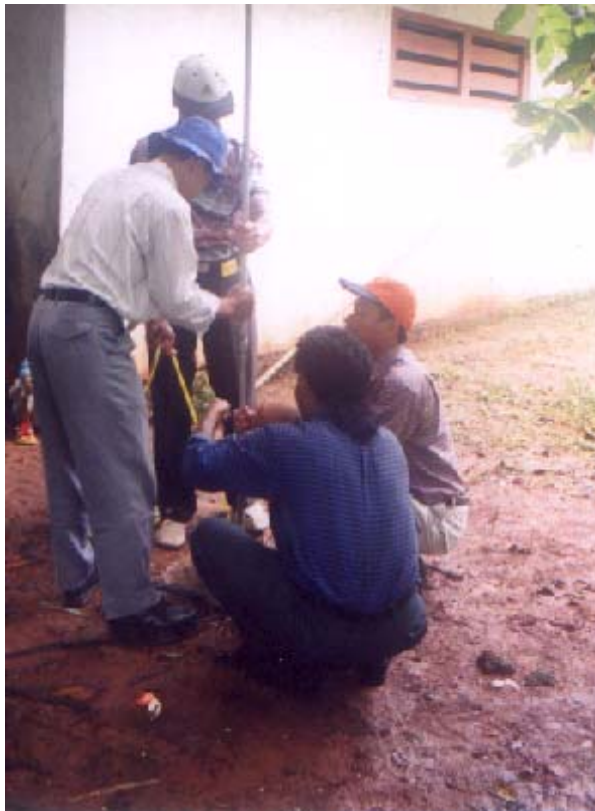
Gambar 1. Proses memasukkan detektor ke dalam sumur (volume air yang dicacah: ± 9 liter)
