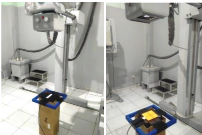
Gambar 1. Uji absorpsi radiasi sinar-X pada sampel komposit apron proteksi radiasi sinar-X
