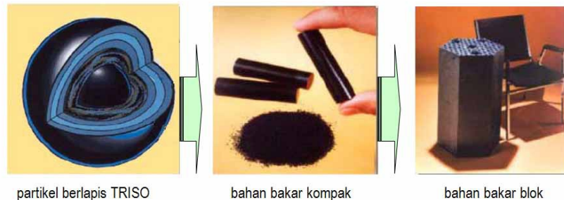
Gambar 1. Skema geometri partikel TRISO, bahan bakar kompak dan bahan bakar blok VHTR (1) .
