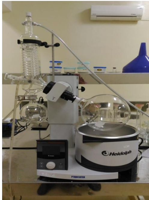
Gambar 3. Labu putar untuk perendaman, pencucian dan pengeringan vakum
