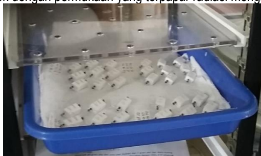
Gambar 4. Detektor CR-39 dikeringkan dalam desikator elektrik.
