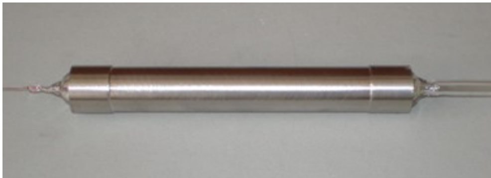
Gambar 6. Hasil perakitan tabung detektor Geiger-Mueller.
