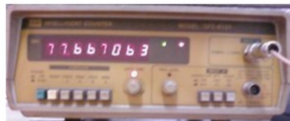
Gambar 15. Tampilan frekuensi pada saat exciter diprogram 77,667 MHz
