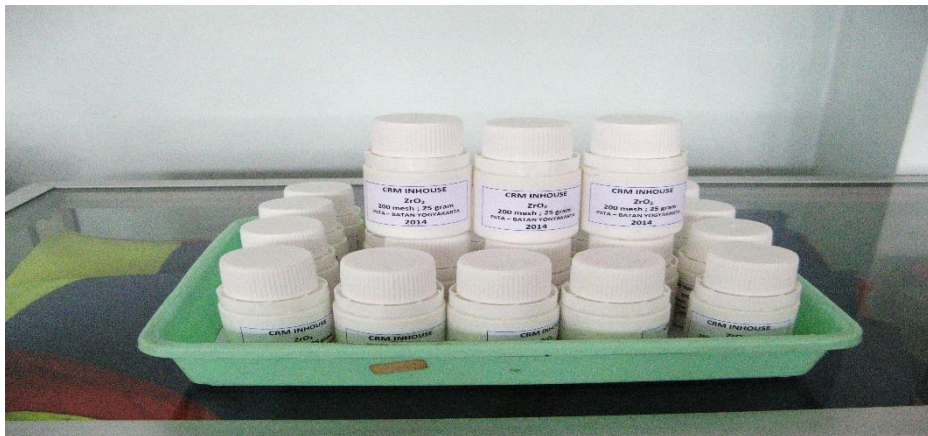
Gambar 2. Prototip serbuk CRM-inhouse zirkonia hasil olah pasir zirkon Kalimantan, lolos 200 mesh sejumlah 20 botol kemasan 25 g.
