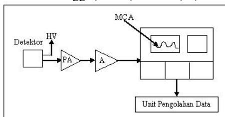
Gambar 2. Diagram Skematik Susunan Perangkat Spektrometer Sinar Gamma
