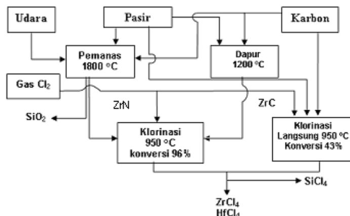
Gambar 1. Blok diagram proses kering pembuatan  $ZrCl_4$  dari pasir zirkon
