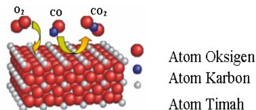
Gambar 1. Skema dari material sensor SnO 2 .
