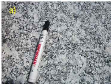
Gambar 7. a). Tekstur janerik Granit Menumbing berukuran kasar dengan biotit melimpah. b). Penampakan alterasi berupa serisit (pinnit) pada kordierit dan inklusi zirkon.
